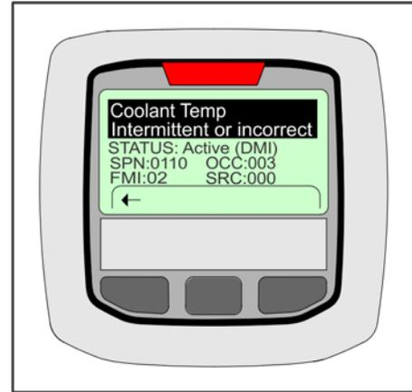
**Figure 3-9. Engine Diagnostic Screen**
