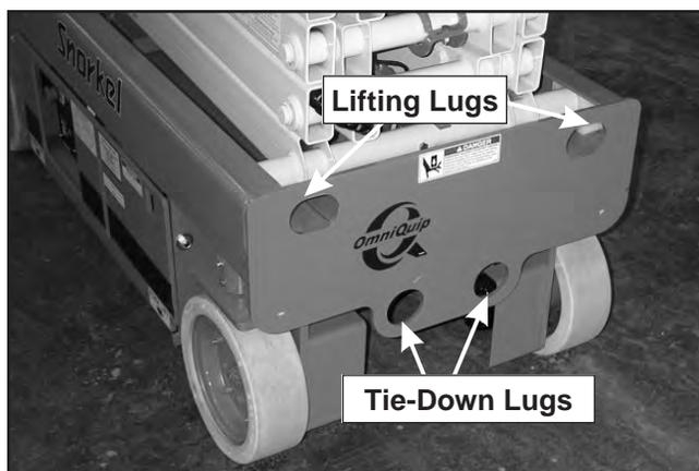
Figure 10.4—Tie-Down and Lifting Lugs
