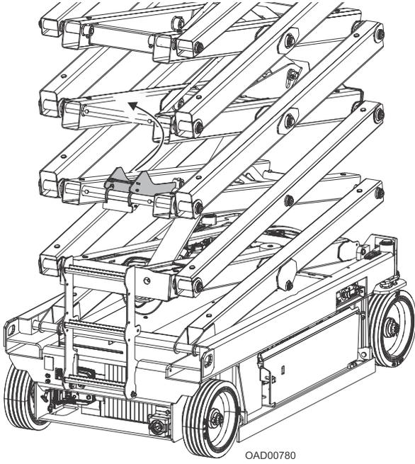
**Figure 12. Prop Disengaged**
